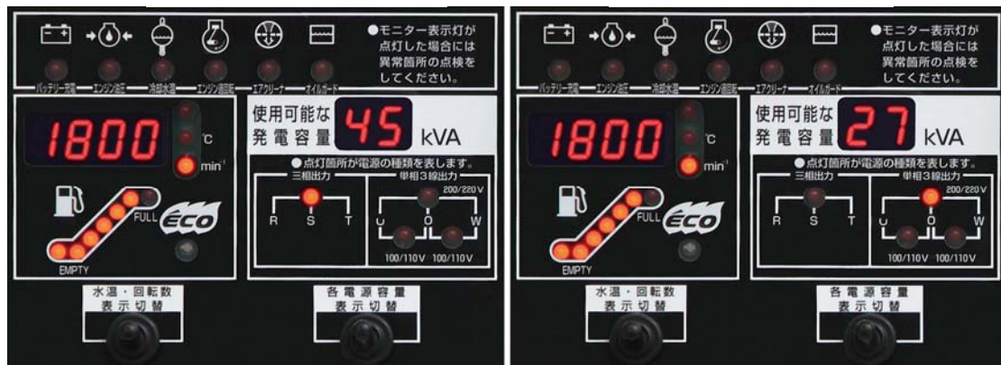
図三 残容量デジタル表示例 (三相、単相3線)
