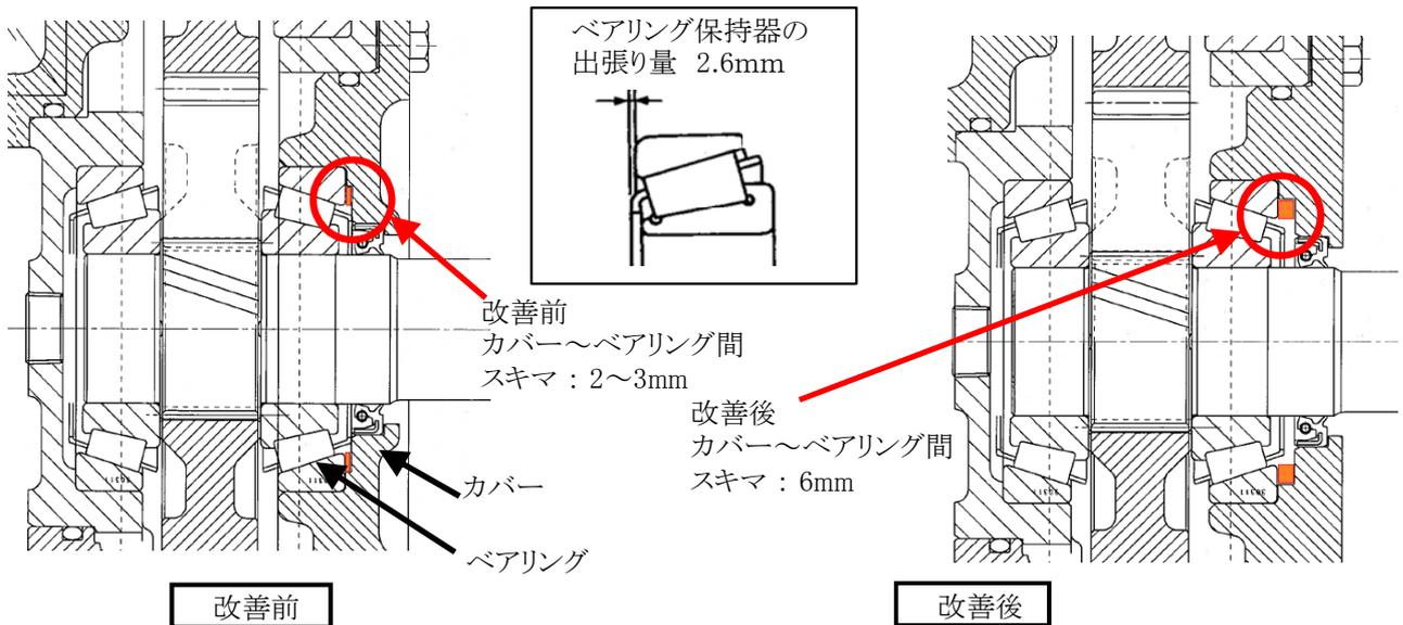
動力伝達装置の減速機において、減速機入力軸のベアリングと取付カバーの隙間が不適切なため、ベアリングとカバーが干渉するものがある。そのため、ベアリングが損傷し、そのまま使用を続けると、最悪の場合、減速機入力軸が固着し原動機が停止するおそれがある。
