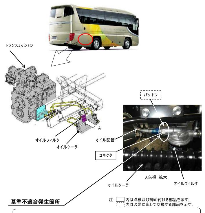
大型観光バスのトランスミッションのオイル配管において、オイルフィルタに組付けてあるコネクタの締結が不適切なため、オイルが漏れるものがある。そのため、そのままの状態で使用を続けると、最悪の場合、トランスミッションが焼き付き、走行不能となるおそれがある。
