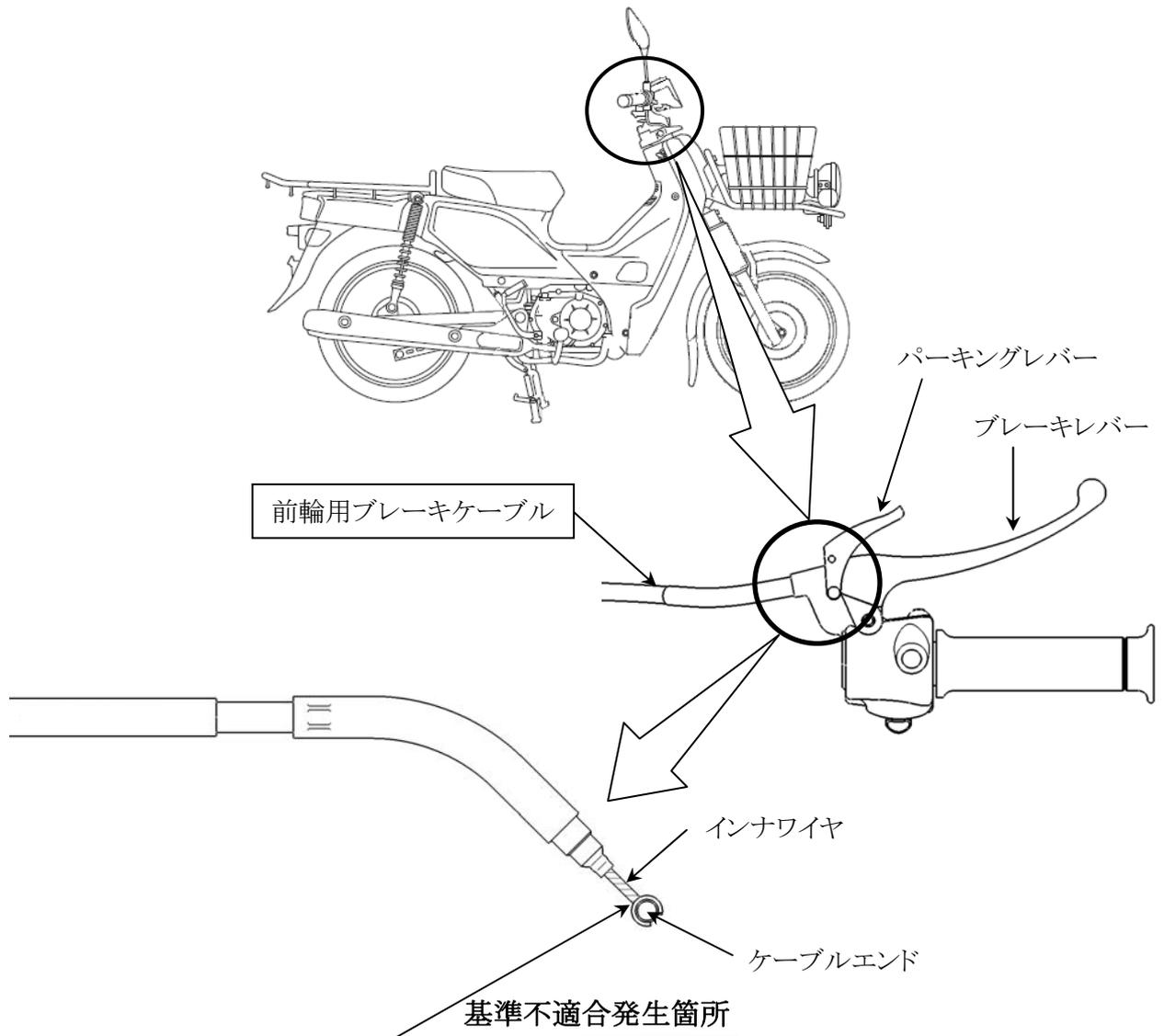
前輪ブレーキにおいて、ケーブルエンドへのインナワイヤ鑄込み位置が不適切なため、坂道などの駐停車時に使用するパーキングレバーの操作を繰り返し行くと、ケーブルエンドが破損し、前輪ブレーキが利かなくなるおそれがある。
