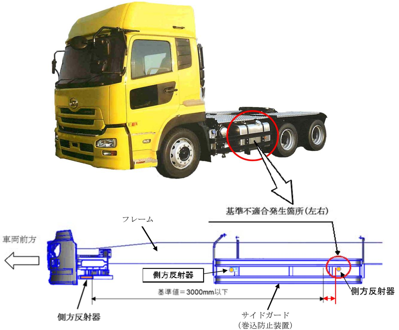
トラクタ（全長6m超え）に備える左右の側方反射器の取付け位置が不適切なため、保安基準第35条の2（側方灯及び側方反射器）の規定寸法に適合しない。
