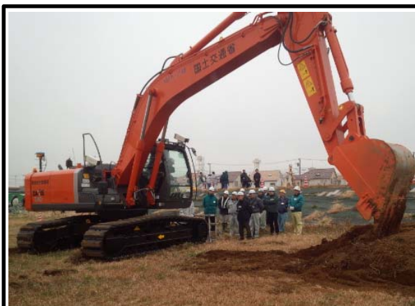
(一社)建設機械レンタル協会の協力によるMGバックホウの機能・効果説明。 ※関東地整保有の分解型バックホウを使用
