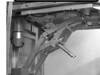
換気口浸水防止機
