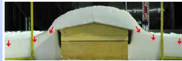
屋根雪と地上雪がつながった 場合の積雪表面の動き
