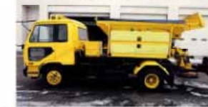
粒状材及び液体の両方散布が可能
