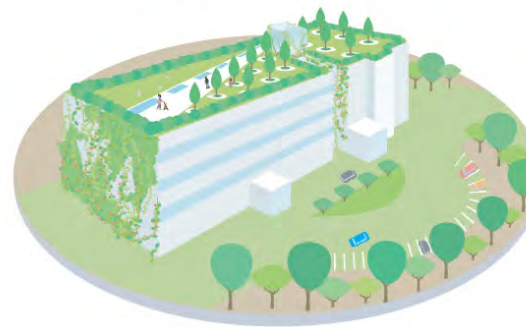
④屋上緑化・壁面緑化
