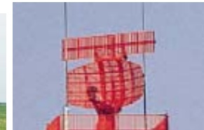
【空港監視レーダー】
