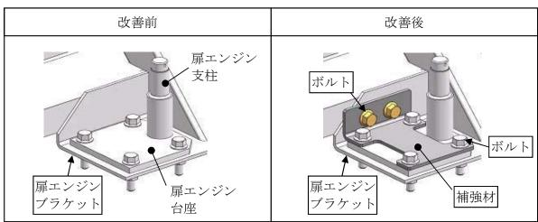
路線バスのグライドスライド扉において、扉エンジンブラケット製造時の曲げ加工が 不適切なものがある。そのため、ブラケット端部に亀裂が発生し、そのままの状態で使 用を続けると、ブラケットが破損し、最悪の場合、扉の開閉ができなくなるおそれがあ
