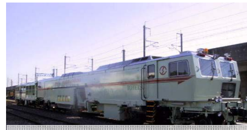
スイッチマルチ (分岐器用道床つき固め機械)
