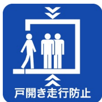
戸開走行保護装置の設置済みマーク
