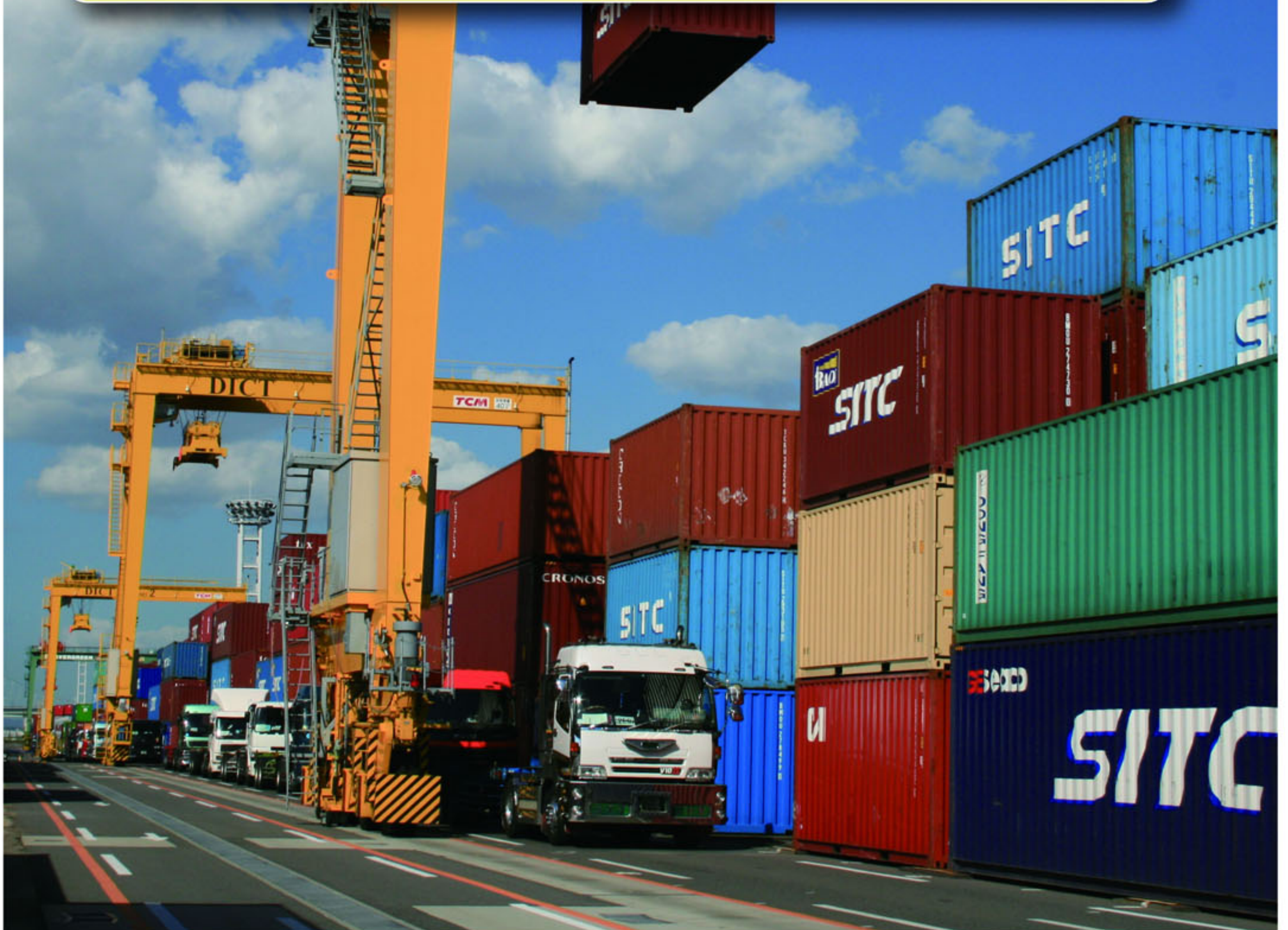
阪神港での荷役作業。コンテナの種類は、主に全長20フィート・40フィートの2タイプがある。コンテナターミナルでは、列をなすトラックの荷台に次々とコンテナが積載されていく。
