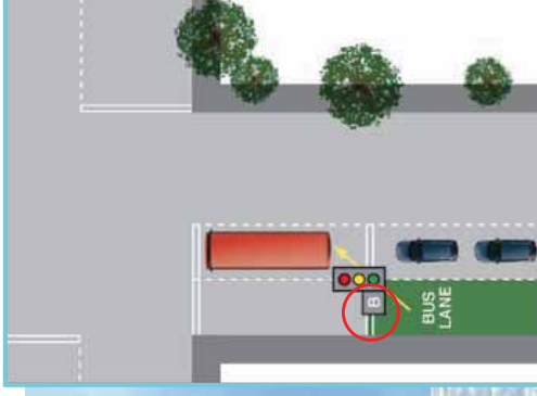
バスレーンとバス専用信号 (クライストチャーチ HP より：NZ)
