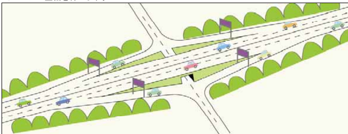
図 スマートインターチェンジの整備イメージ（本線上への整備例）
