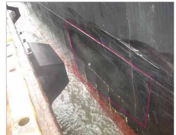
接岸中にうねりの影響で何度も防舷材に打ち付けられ船体に凹みが生じた事例
