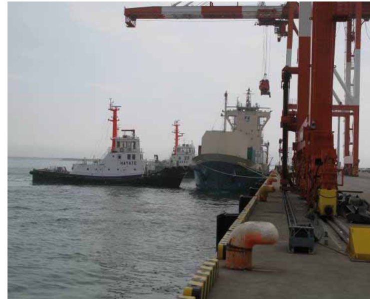
静穏度が確保されておらず、うねりの影響を受けるため、タグボート2隻で岸壁に押付け、荷役作業を実施
