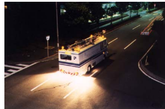
路面性状自動測定装置による調査
