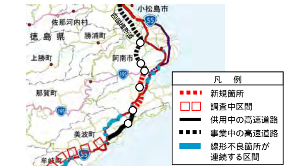
図4 国道55号線形不良区間
