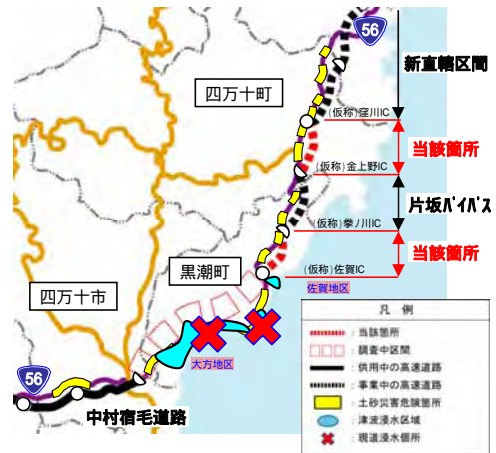
図2 国道56号浸水箇所想定と土砂災害危険箇所 土砂災害危険箇所は現道に影響があると考えられる土石流危険渓流を対象としている
