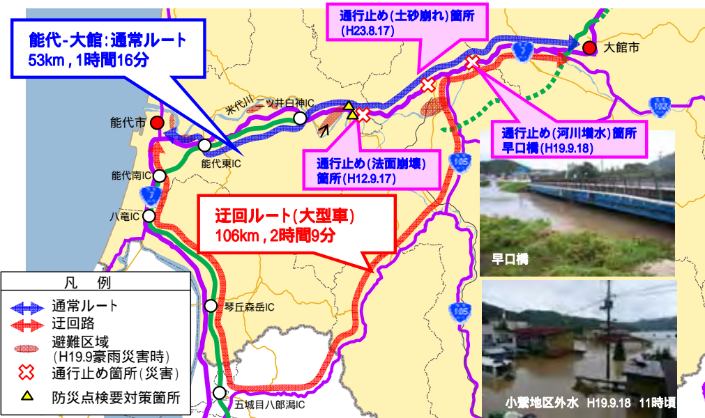
図2 能代市～大館市間の国道7号の通行止めと迂回状況等
