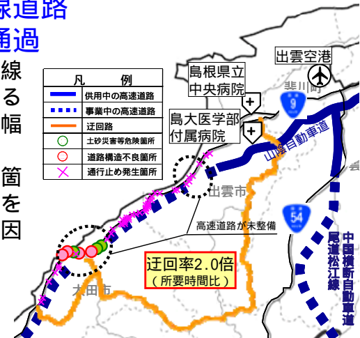
図3 土砂災害危険箇所等及び迂回路状況
