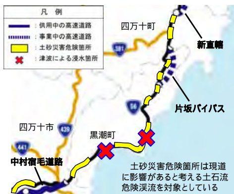
図1 津波による国道56号の浸水箇所
