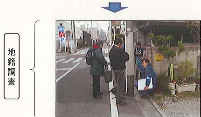
調査結果等を基に、土地所有者の立会いによる官民境界の確認
