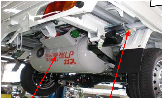
燃料ガスタンク 燃料ガス充填口
