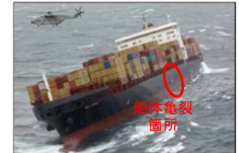
大型コンテナ船の船体折損事故 (2007年1月 コンテナ船MSC NAPOLI)
